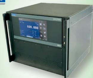
Rango de medición: 0 ... 100 bar a 0 ... 700 bar
