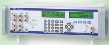
Rango de medición: ■ 0 ... 100 mA, 0 ... 100 V, 5 ... 4.000  $\Omega$
