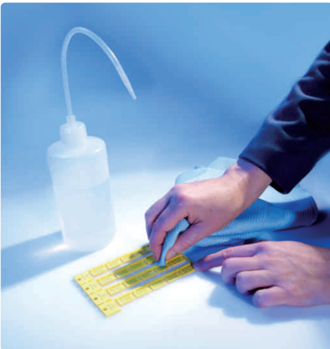
Ensayo de resistencia a roce
