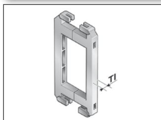
Empalme de traviesas
