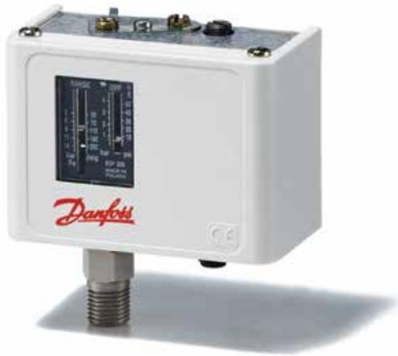
Los presostatos KP de Danfoss se utilizan para sistemas de control, monitorización y alarma en aplicaciones industriales. La serie KP es idónea para medios gaseosos y aire. Están equipados con un conmutador unipolar (SPDT) y permiten controlar directamente motores monofásicos de corriente alterna de hasta 2 kW.
