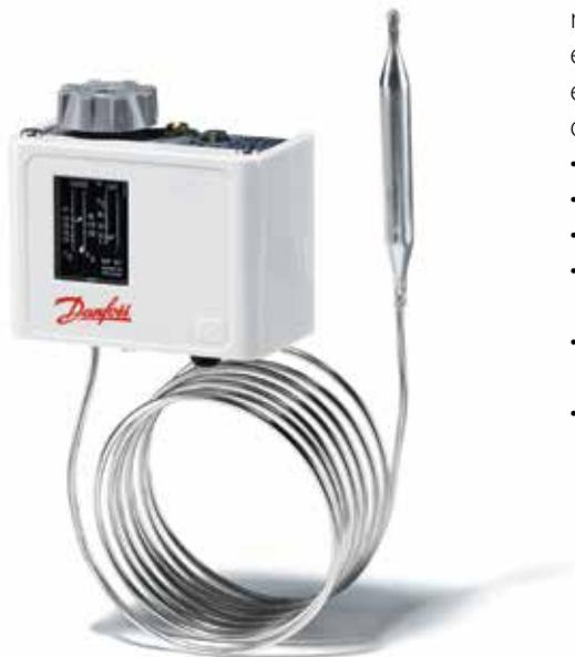
Los termostatos KP de Danfoss se utilizan para sistemas de control, monitorización y alarma en la industria. La serie de termostatos KP está integrada por interruptores eléctricos activados por temperatura, equipados con un conmutador unipolar (SPDT) que puede controlar directamente motores de corriente alterna monofásicos de hasta 2 kW.
