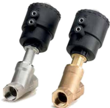
La AV210 es una Válvula accionamiento externo de activación externa, diseñada para utilizarse en equipos industriales robustos. Esta válvula puede funcionar a temperaturas y viscosidades del medio muy elevadas y es resistente a las partículas de suciedad del medio; por eso, a menudo recibe el nombre de válvula "a prueba de fallos". Está disponible en bronce de cañón (RG5/ bronce) y acero inoxidable (AISI316).
